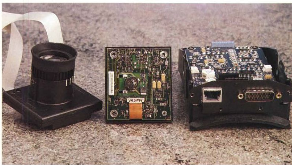
Le ottiche, l'elettronica interna alle ottiche in cui è integrato il visore ad LCD TFT da 0.7 pollici, la scheda di controllo dei visori e del sistema di tracciamento della posizione del capo dello sperimentatore.
